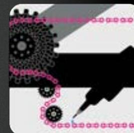
Auftragen: Die Kurbel langsam rückwärts drehen, damit es gleichmäßig auf alle Kettenglieder verteilt wird.
